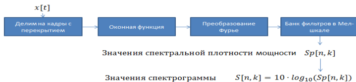
Рисунок 1 – Схема получения спектрограммы сигнала ( n - номер кадра; k -номер фильтра)
